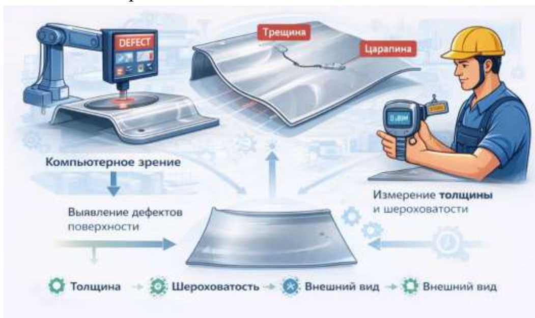
Рис. 2. Проверка качества поверхности листовой штамповки
