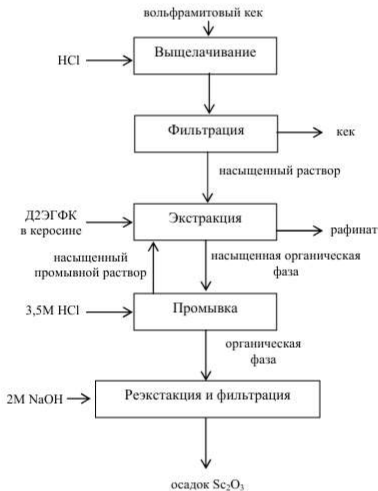
Рисунок 2. - Принципиальная технологическая схема извлечения скандия из вольфрамового кека
